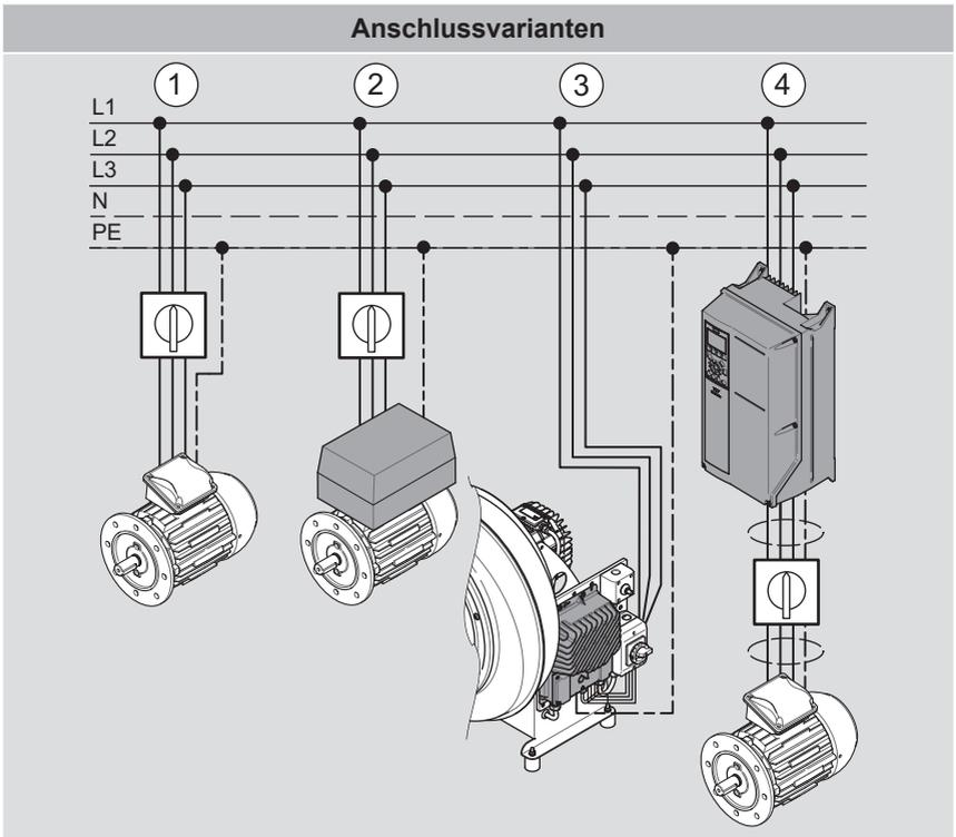
Je nach Ausführung lässt sich ein Elektromotor entweder direkt (1) an das elektrische Netz anschliessen oder kann/muss mit einem FU betrieben werden.
