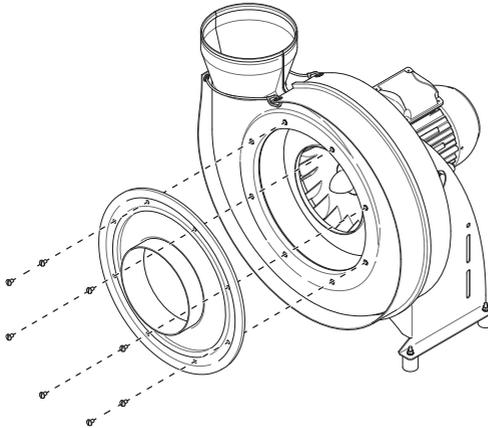
Abb. 36: Ansaugdeckblatt demontieren
