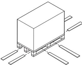
Ein Packstück auf einer Palette kann mit einem Hubwagen oder Gabelstapler unter folgenden Bedingungen transportiert werden:
