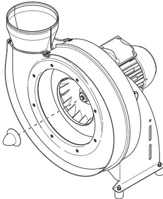
Abb. 37: Nabenkappe entfernen
