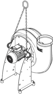
Zum Transport eines unverpackten Ventilators eine zweisträngige Anschlagkette verwenden.
