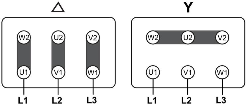
Abb. 34: Anschlussbelegung für Dreieck- und Sternschaltung
