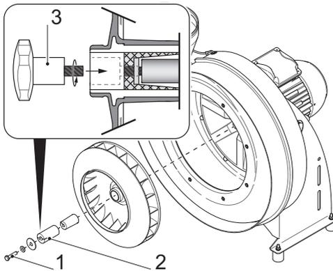
Abb. 38: Laufrad demontieren
