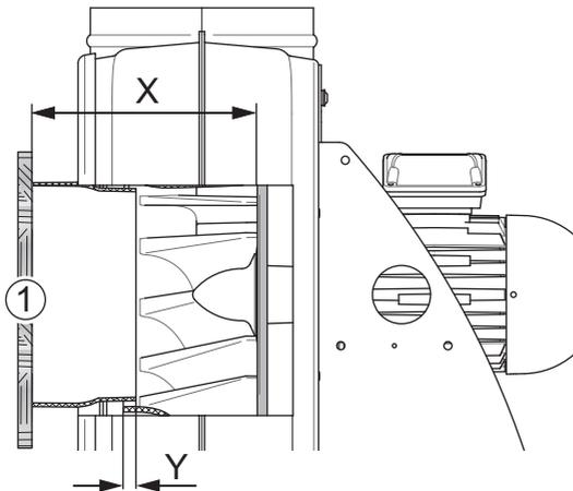
Abb. 41: Laufradposition messen (Schnittdarstellung)
