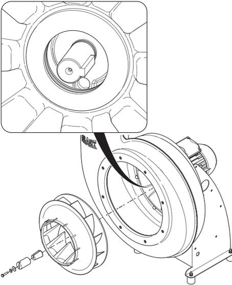
Abb. 43: Filzring Nabendichtung ersetzen
