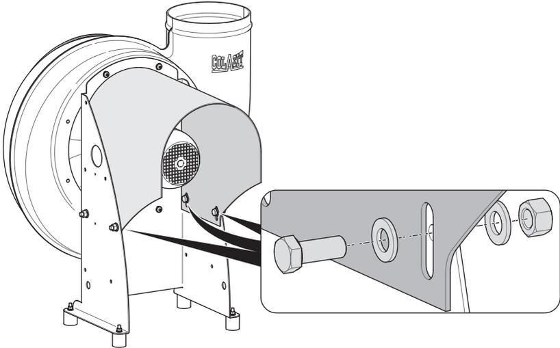
Abb. 35: Motorabdeckung montieren (DA)
