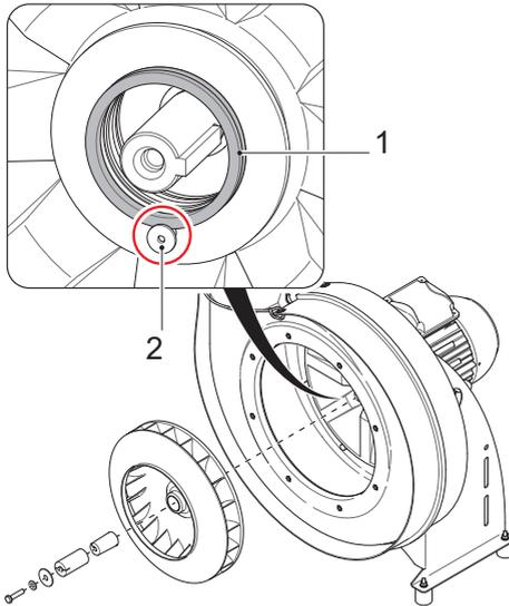
Abb. 42: V-Ring Dichtung ersetzen
