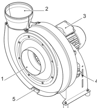
1. Eintrittsstutzen (saugseitig): Anschluss an Zuluftrohrleitung mit Manschette.
