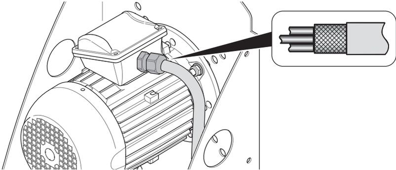
Abb. 33: EMV-Kabelverschraubung
