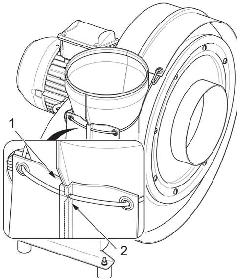
Korrekte Montage des Splitterschutzes prüfen:
